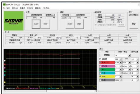
PC上で本体の操作が可能で、回転数、トルクなど測定条件および測定結果を表示できます。また、攪拌動力、動力数、Pv値、攪拌Re数、参考粘度などを同時に算出及び表示できます。経時変化に対するグラフ作成機能を備えると共に、CSV形式でのデータの保存が可能です。
